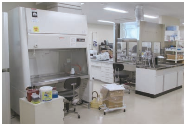
検体保存に使用する安全キャビネット(左)と独立した換気装置を備えた染色ブース(右)
