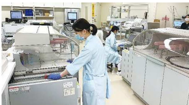
生化学自動分析機(生化学・免疫検査室)
