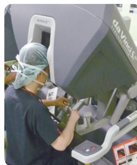
術者はコンソールに入りロボットを操作します。同じ手術室内に設置されています。
