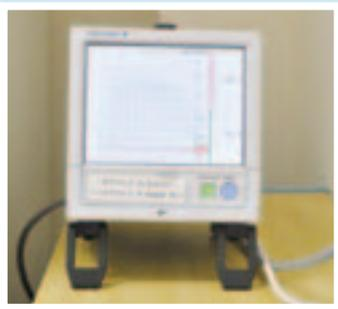
フリーザー室では、PCによる温度監視・警報システムが部屋の温度変化を感知するシステムと、個別のフリーザーの温度変化を感知するシステムとの二重監視の方式で行われています。
